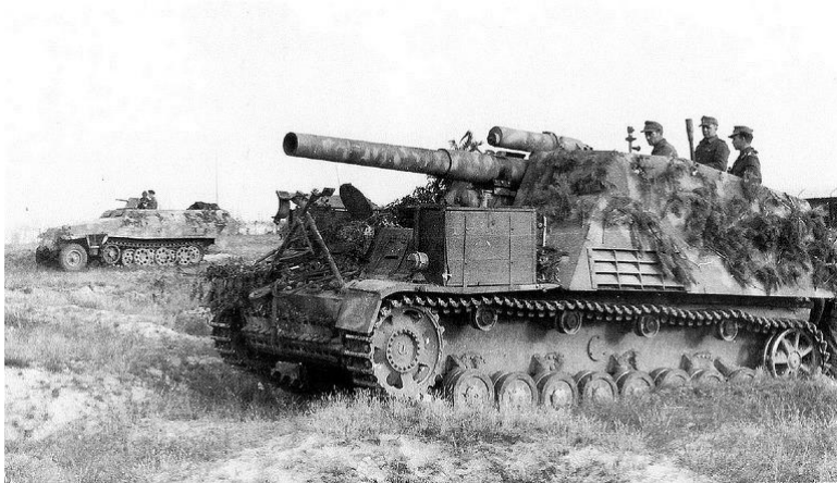
Der Geschützswagen III/IV für s.F.H. 18/1 (Sf) (Sd.Kfz. 165) „Hummel“ beziehungsweise die schwere Panzerhaubitze auf Sd.Kfz. 165 war eine Selbstfahrlafette mit einer Haubitze im Kaliber 150-mm. Sie wurde von der deutschen Wehrmacht im Zweiten Weltkrieg von 1943 bis zum Ende des Krieges eingesetzt.
